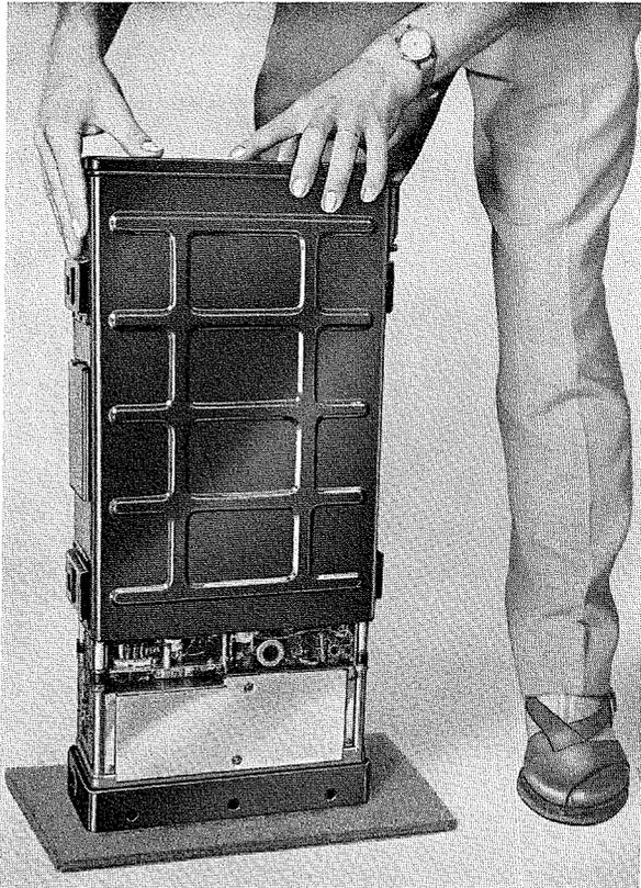
Bild 18 Abziehen des Gehäuses vom SE-Gerät
