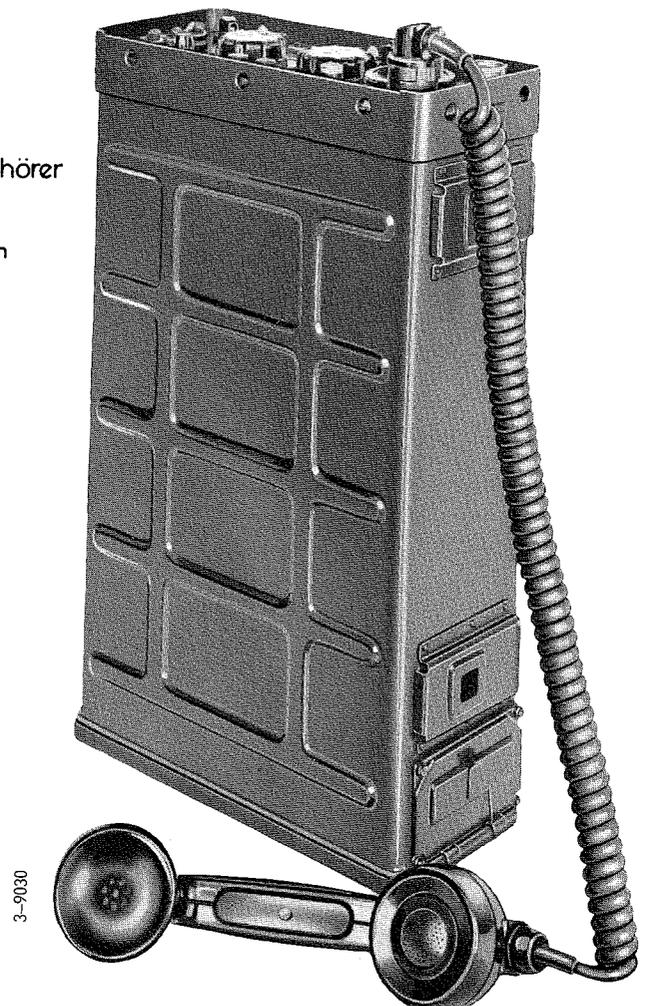
Bild 107 Funksprechgerät FuG 7a mit angeschlossenem Handsprechhörer →
