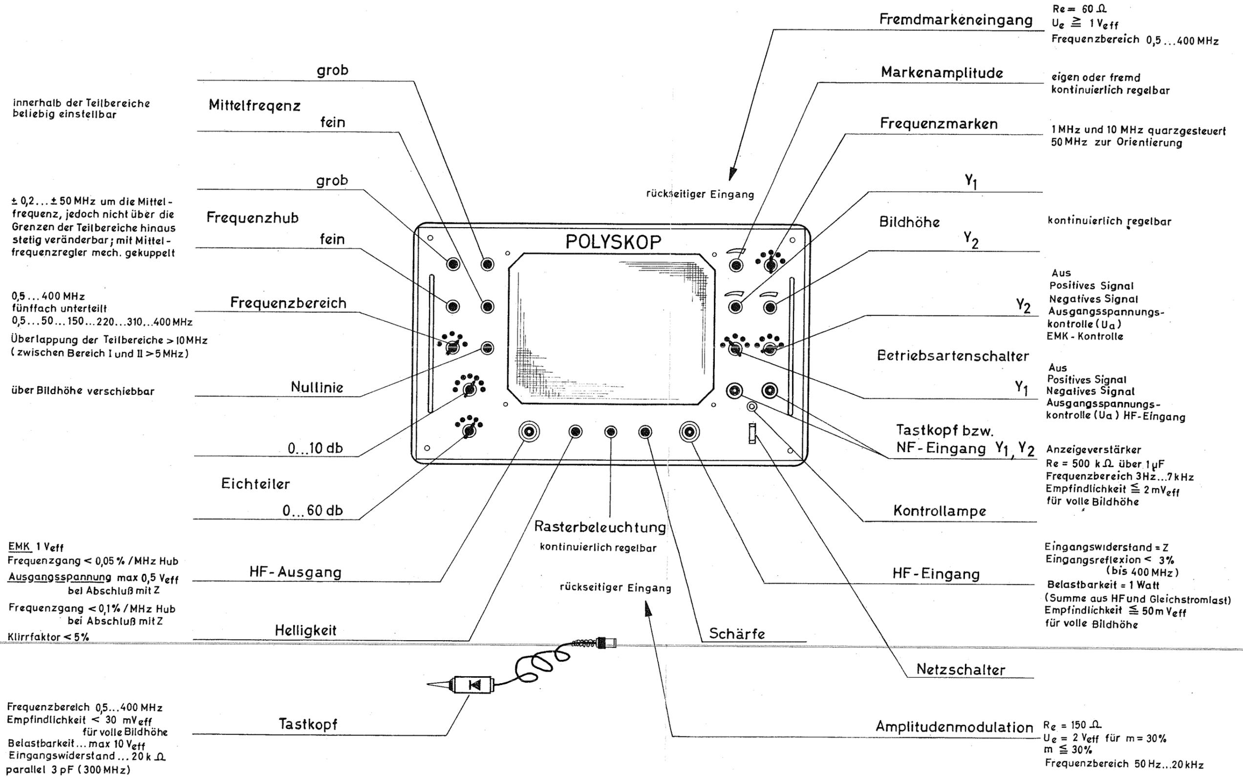
Bild 2. Technische Daten des Polyskop
