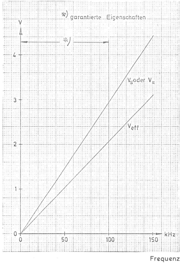
Bild 7 Modulationsspannungsbedarf des SMSF in  $V_{eff}$  und  $V_S$  oder  $V_-$
