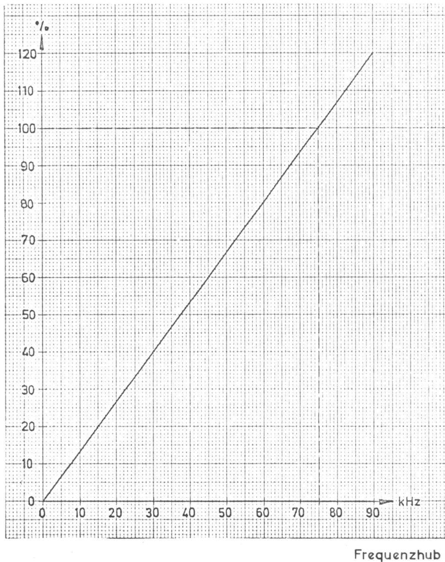
Bild 6 Frequenzhub des SMSF in Abhängigkeit von der Aussteuerung des Stereo - Coders MSC
